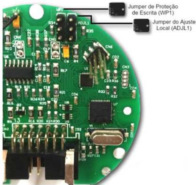
Figura 3.2 – Detalhe da placa principal com jumpers.
