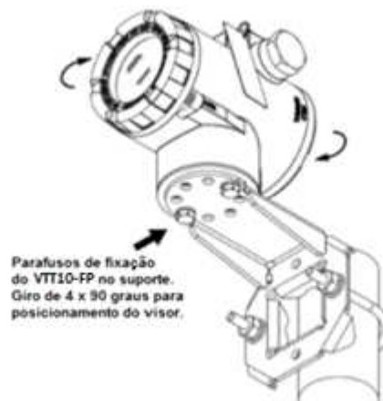
Figura 2.3 – Ajuste da posição da carcaça.
