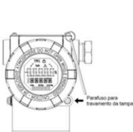
Figura 2.2 – Trava da tampa com visor.
