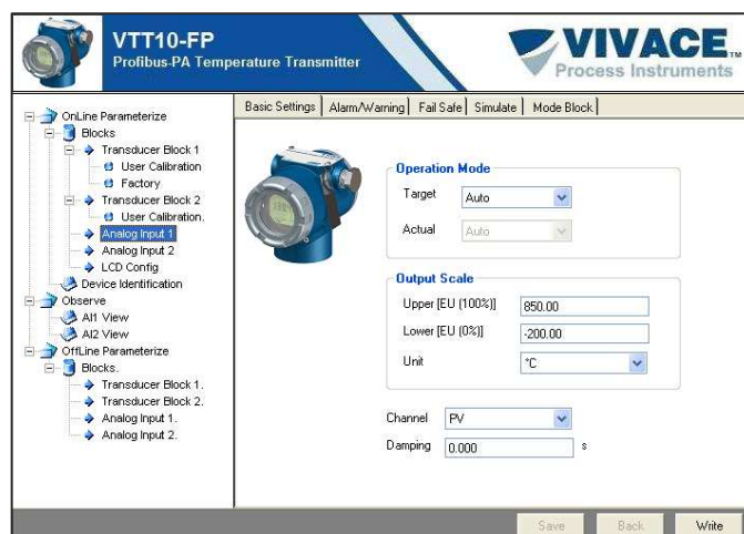
Figura 3.8 – Tela de configuração do bloco AI.
