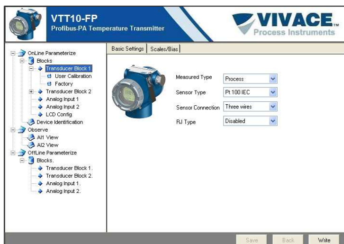
Figura 3.7 – Tela de configuração do sensor do VTT10-FP.
